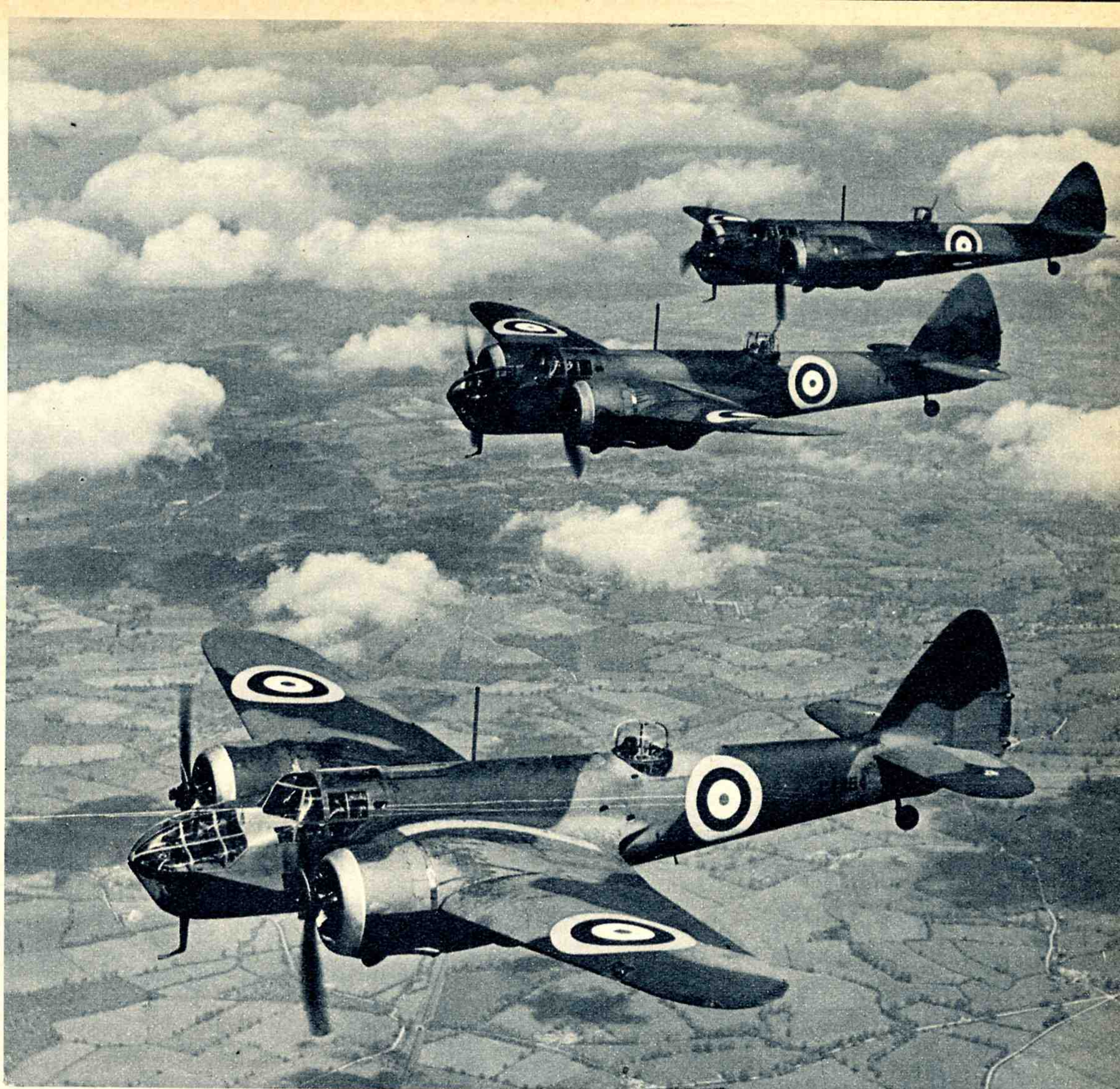
Eine Kette Kampfflugzeuge Bristol „Blenheim“ auf Übungsflug. Deutlich erkennbar ist die gläserne Bugkanzel und der Führerraum, dessen zahlreiche Fenster gute Sicht nach allen Seiten ermöglichen. Der kleine Mast vor dem MG dient zur Befestigung der Antenne
