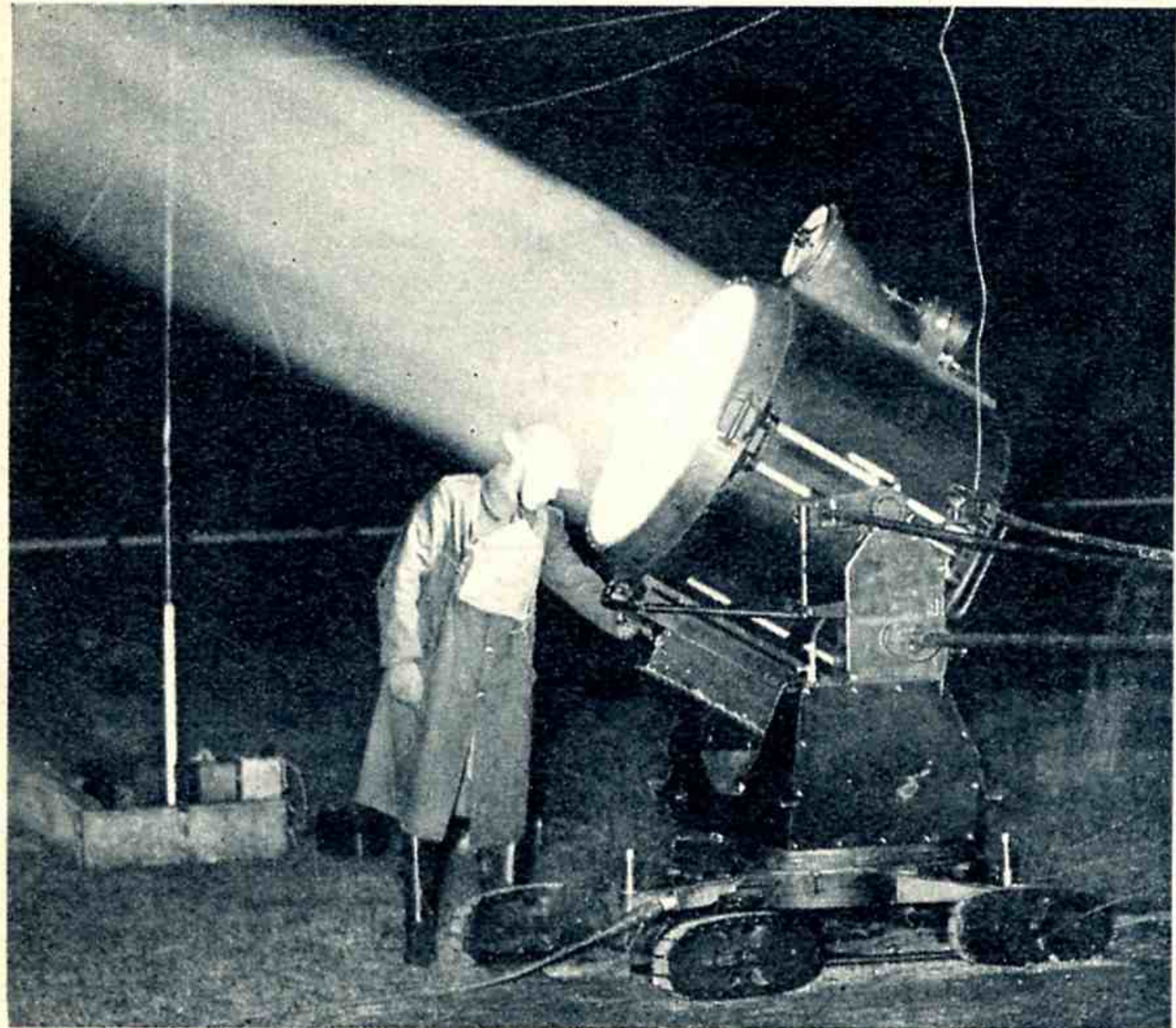
Praktische Übungen am Scheinwerfer. Am Gerät ist der Ausleger mit dem Handrad erkennbar. Der Scheinwerfer ist auf geländegängigen Raupenrädern montiert
