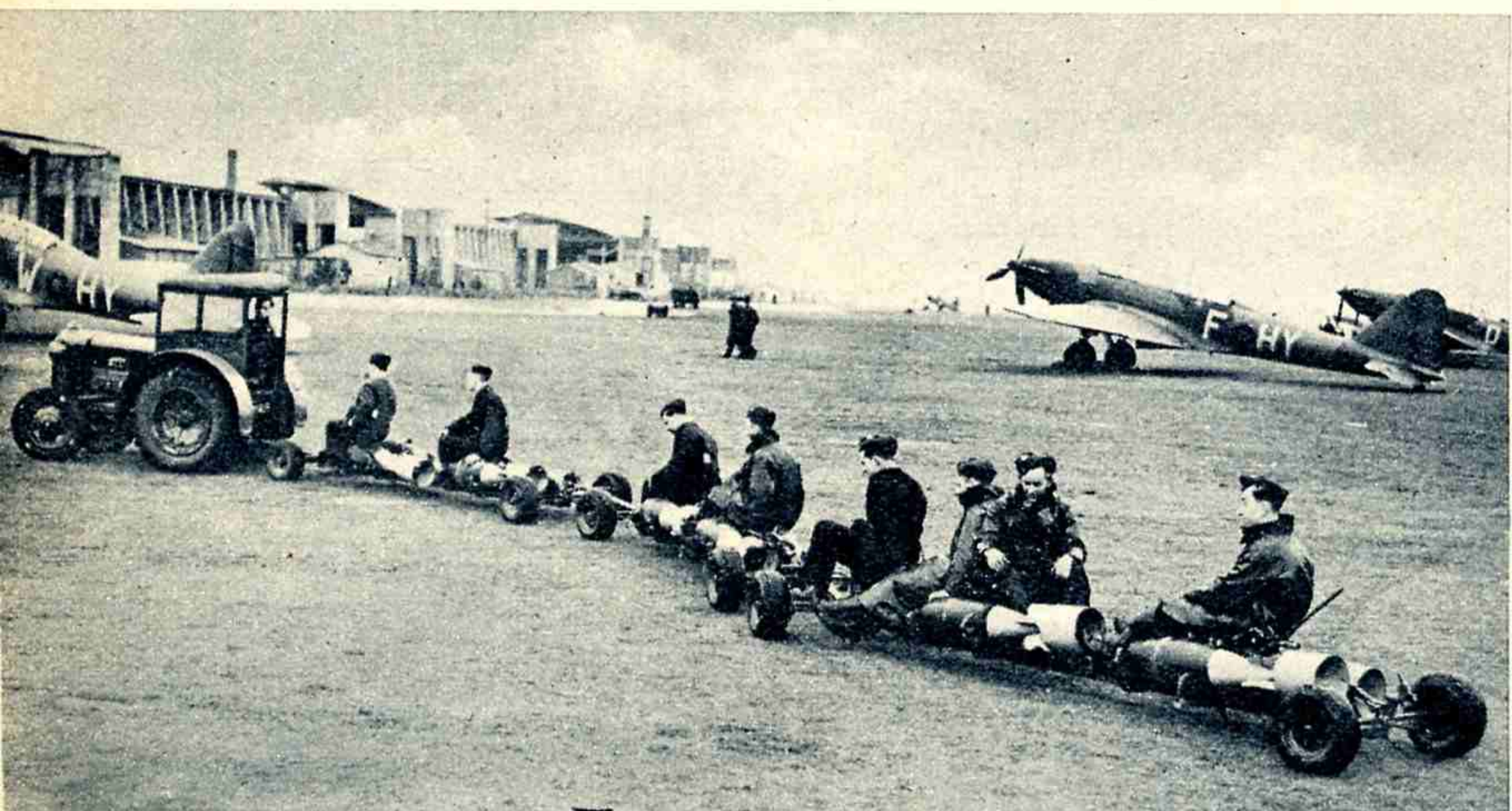
Der „Bombenzug“ unterwegs. Auf diese originelle Weise werden Bomben vom Munitionslager zu den Flugzeugen gebracht
