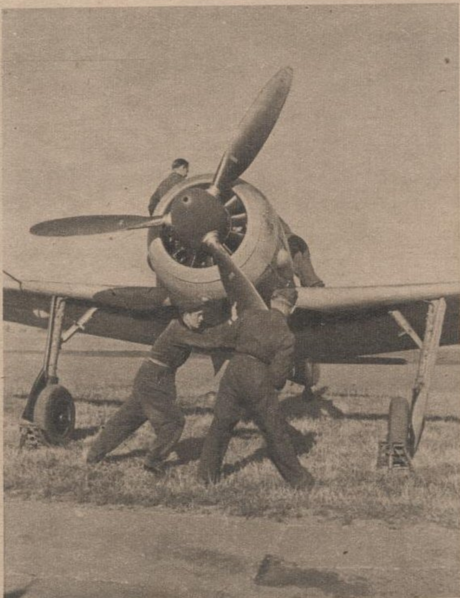
Démarrage du moteur avant le départ. Le monoplace de chasse Fw 190 est équipé d'un moteur BMW à 14 cylindres en double étoile de la plus grande puissance
