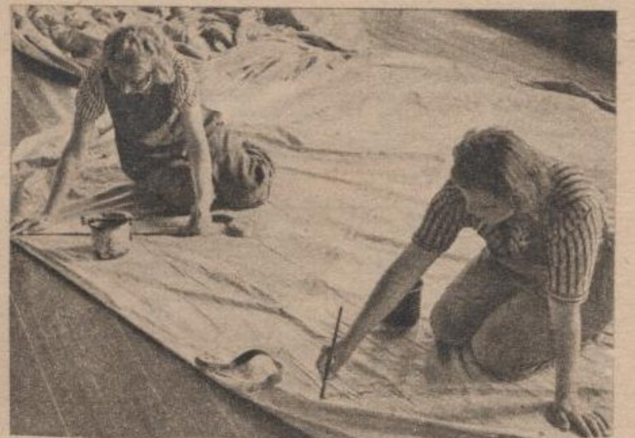
Quand l'ingénieur a vérifié les coutures des panneaux de renforcement, on colle les sangles qui confèrent une plus grande résistance à l'enveloppe extérieure du ballon
