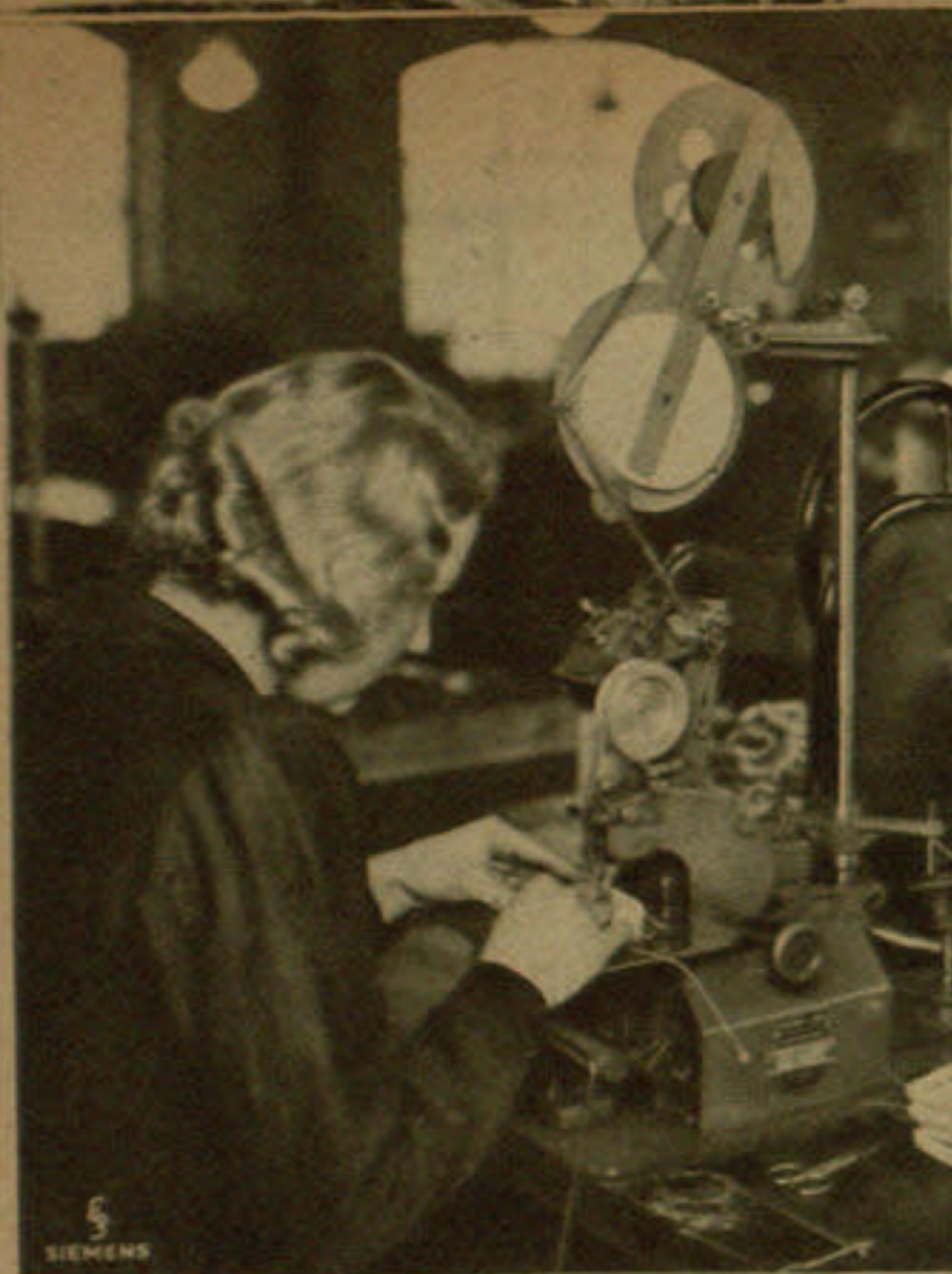
Mit der Bandagiermaschine werden die Ständerspulen eines Motors einbandiert Werkfoto Siemens
