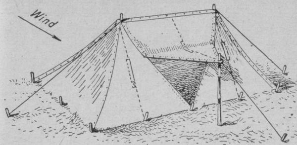
zuknüpfen. Die Zeltspitzen werden durch je einen dreieckigen Zeltstock hochgestützt, die auf dem Boden liegenden Seiten der Zeltbahnen werden mit den Zeltpflocken fest auf die Erde verpflockt. Um das Zelt wird ein kleiner Graben angelegt, damit das Wasser bei Regen ablaufen kann. Die auf dem Boden aufliegenden Teile der Zeltbahnen werden mit Erde zugeworfen, um das Zelt nach unten möglichst luft- und wasserdicht abzuschließen.
