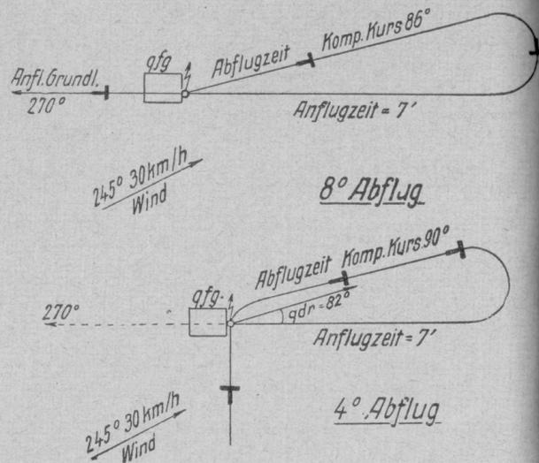
Gelangt das Flugzeug in diesem Beispiel auf Ostkurve an den Zielhafen (s. Skizze Seite 119), so ist auf „Platz“ der Abflugkurs durch eine geringe Verbesserung aufzunehmen. Er beträgt, da das Flugzeug durch die später zu fliegende 180°-Rechtskurve um 8° veretzt wird, nicht 94° sondern 86°. QDR-Beilungen während des Abfluges müssen 82° lauten.
