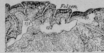
Die Böschungen werden in Bergstrichen von 1°-5° nach Müffling'schem über 5° nach Lehmann'schem System dargestellt; im Hochgebirge kommen außerdem Schichtlinien in Stufen von 100 m zur Anwendung.
